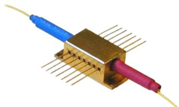
Однопроходный полупроводниковый оптический усилитель на основе квантово-размерных структур. Модуль в корпусе Butterfly содержит фотодиод обратной связи и термоэлектрический охладитель (ТЭМО). Излучение выходит из одномодового волокна (или из волокна с сохранением поляризации) длиной 0,5 - 0,9 м. Оконцован коннектором FC/APC.
