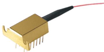
Суперлюминесцентный модуль для оптических датчиков и измерений. Модуль в корпусе 14pinDIL содержит фотодиод обратной связи и термоэлектрический охладитель (ТЭМО). Излучение выходит из одномодового волокна (или из волокна с сохранением поляризации) длиной 0,5 - 0,9 м. Оконцован коннектором FC/APC.
